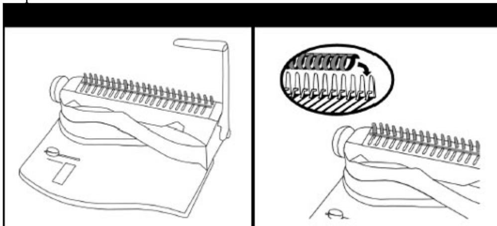
4. Отведите ручку зажима/разжима пружины к себе (против часовой стрелки), чтобы открыть пластиковую пружину.
