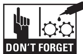
Смазывайте режущий механизм маслом при уменьшении производительности, возникновении шумов или после каждого опорожнения сборного резервуара (только при нарезке на частицы):
