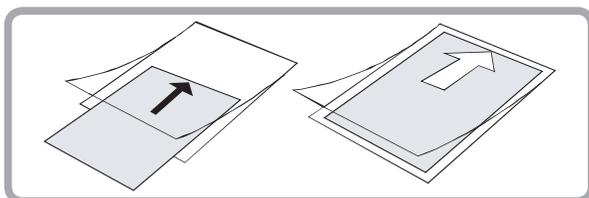
4. Когда загорится индикатор готовности Вложите пленку закрытым концом прямо в ламинатор через входную щель. Проталкиваемая пленка должна коснуться вала, аппарат автоматически начнёт процесс ламинирования.
