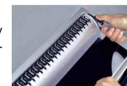
5. Оттяните назад Ручку перфорации/переплета так, чтобы пружина для переплета была разжата на достаточную ширину, и перфорированные листы могли быть легко на нее надеты.
