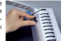
2. Отключите Фиксатор открытой пружины.
