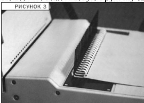
4. Отведите ручку зажима пружины на себя, чтобы открыть пластиковую пружину.
